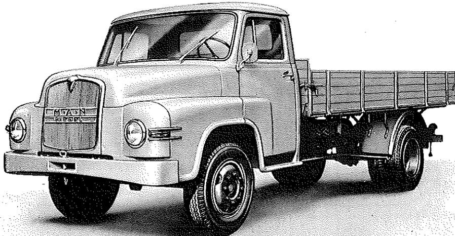
**Diesel-Motor · 6 Zylinder · 4-Takt · 120 PS bei 2700 U/min**
